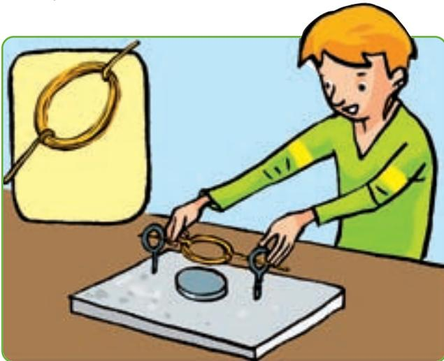
3. Eliminad el esmalte de los dos extremos que sobresalen de la bobina e insertad los ejes de la bobina en las alcalayatas.
