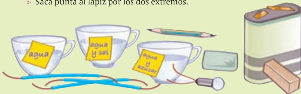
2. Ahora monta un circuito abierto con la pila, los cables y el detector de corriente del modo que se muestra en la figura. Después, cierra el circuito utilizando cada uno de los materiales y observa lo que ocurre en cada caso. Toma nota de los resultados.
